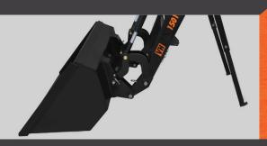
El mecanismo multiplicador permite mayores ángulos durante la carga y descarga. El enganche rápido al aditamento facilita su montaje y desmontaje en cuestión de minutos.
