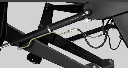
Cilindros de doble efecto de gran durabilidad fabricados con tubo honeado y barra cromada.
