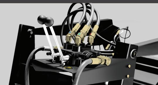
Portaválvulas de posición variable con comando de dos palancas para VH-500-ER. Como equipo opcional está disponible con joystick.
