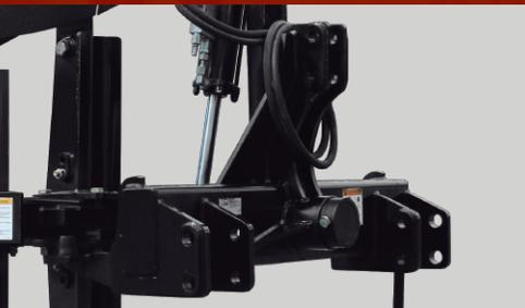
Este tipo de arado es el implemento agrícola ideal para levantar la tierra de forma regular y voltear los residuos de vegetación existentes en la superficie, consiguiendo una mejor integración y descomposición de los mismos sin dañar la estructura del suelo y disminuir la erosión eólica.
