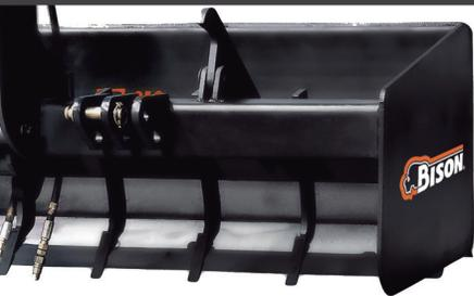
Los timones escarificadores son reemplazables y se colocan en un armazón rectangular accionado hidráulicamente, permitiendo romper la capa superior compactada del suelo.
