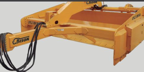
El sistema de eyección está compuesto de dos cilindros laterales sincronizados y auxiliados por cuatro rodillos para expulsar la carga y evitar atascamientos.
