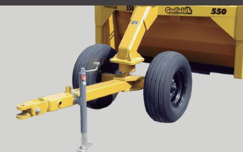
Las llantas delanteras de 8 capas son de 11 pulgadas de ancho para una mayor vida y una mejor flotación.
