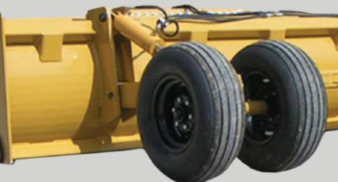
Los dos cilindros de elevación tienen 4" de diámetro interior, 2" de diámetro del vástago y 12" de carrera.
