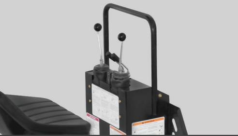
Los controles hidráulicos con joystick en los estabilizadores, el cucharón y los movimientos de los brazos, están a la mano del operador, eliminando la fatiga y simplificando la operación del equipo.
