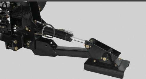
Los estabilizadores con sus pisadores permiten adaptarse a cualquier superficie de trabajo, haciendo la operación más segura al evitar movimientos inesperados.
