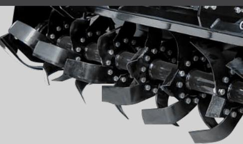
Distribución helicoidal de las cuchillas para normalizar la demanda de potencia.
