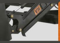
El mecanismo multiplicador permite mayores ángulos durante la carga y descarga.
