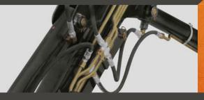
Tubería hidráulica de alta presión de acero con acabado tropicalizado y conexiones anti-goteo estandarizado JIC.
