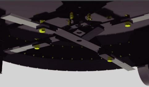
Rotor de 4 najavas, provocando un corte más efectivo y balanceado, además de que las cuchillas no están fijas, aumentando la durabilidad al momento de un golpe.
