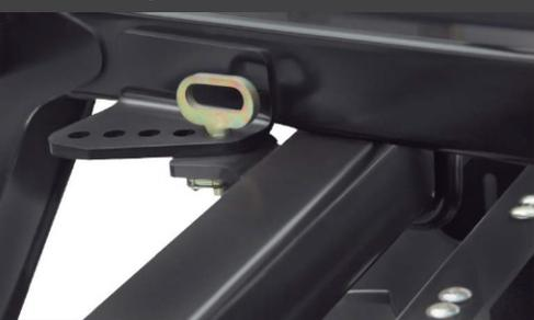
3 o 5 posiciones de ajuste para el ángulo de ataque en ambas secciones de discos, permitiendo un rastreo impecable en cualquier tipo de terreno.
