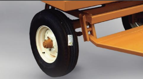
Eje de alto despeje, lanza reforzada y quinta rueda que abarca todo el ancho del chasis para una mayor estabilidad durante la carga y el transporte.
