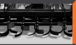
Distribución helicoidal de las cuchillas para normalizar la demanda de potencia.
