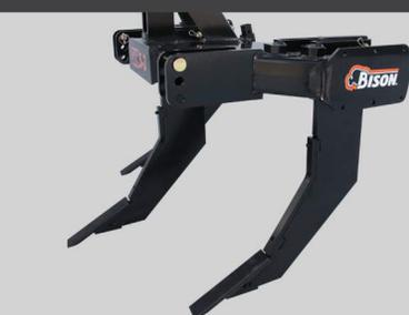
Con timones de altura regulable y de fácil recalzado de las puntas, las cuales son reemplazables.
