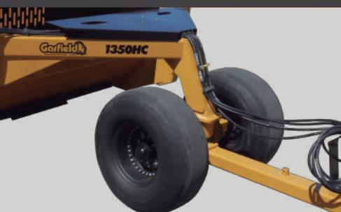
Bloqueo hidráulico para asegurar el transporte.
