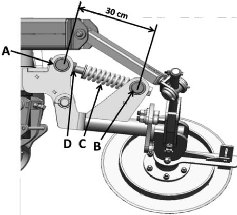
En tierra suelta o arenosa puede ser necesario ajustar la rueda guía más abajo para disminuir la profundidad de corte, o para mejorar su apoyo.
