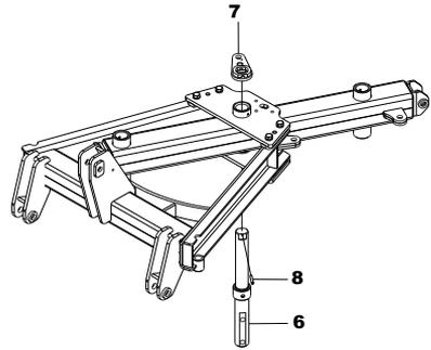
Para el modelo **ADB2-428H2**: Inserte el Pivote central (2a) a través del Larguero (1a) y el Ensamble de placa (3). Coloque en los extremos del Pivote central (2a) la Rondana (3a). Asegúrelas usando pernos rectos (8).
