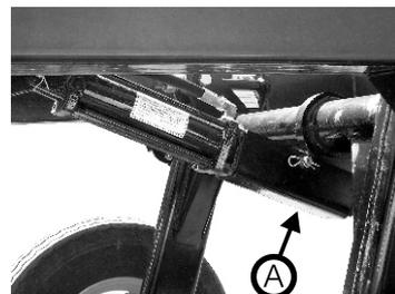
**IMPORTANTE:** Evite daños a la máquina; asegúrese de que el seguro de transporte (A) quede ensamblado en el vástago del cilindro como se ilustra.
